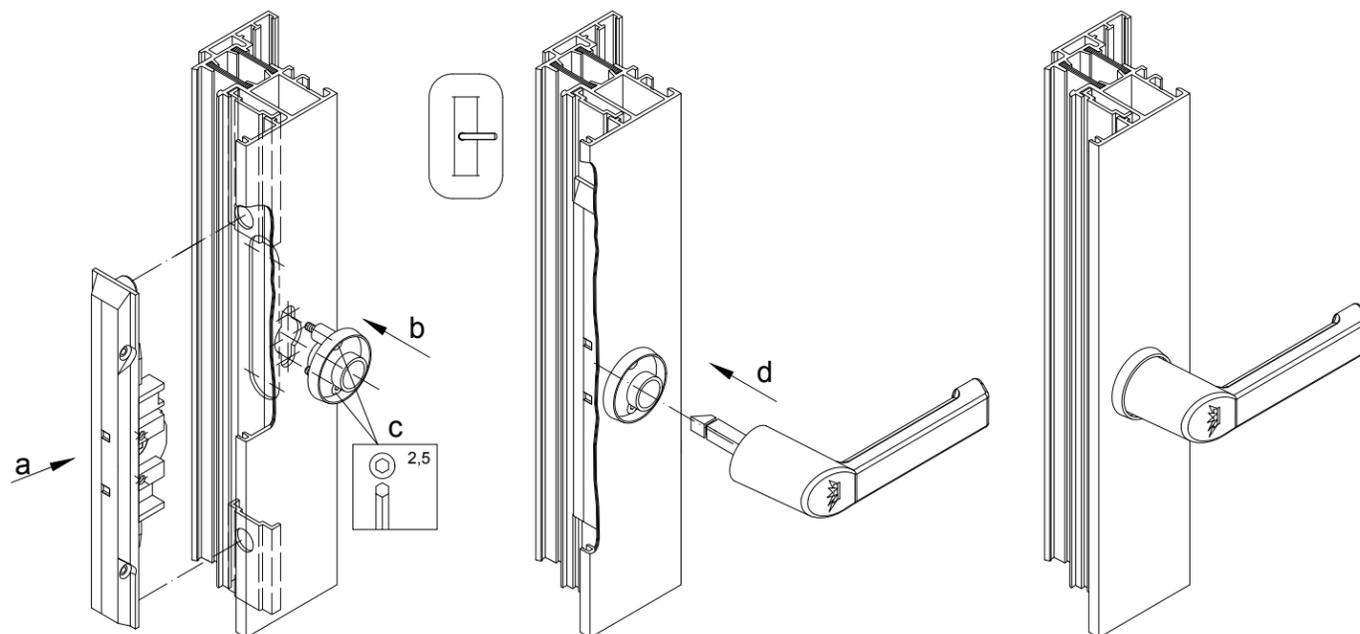
1. Kammergetriebe einführen und mit Riegelstangen koppeln und mit Rosette verschrauben.
