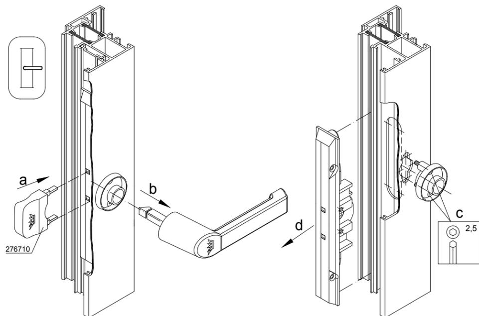
1. Fenstergriff in Drehstellung bringen. Die Rastung mit Demontageschlüssel durch die Bohrung zurückdrücken, bis Fenstergriff heraus springt, oder mit etwas Kraft herausziehen.
